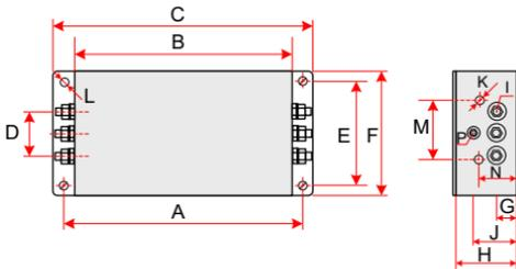
图 7-3 竖力滤波器 DL-25EBK5/ DL-35EBK5/ DL-50EBK5 尺寸图
