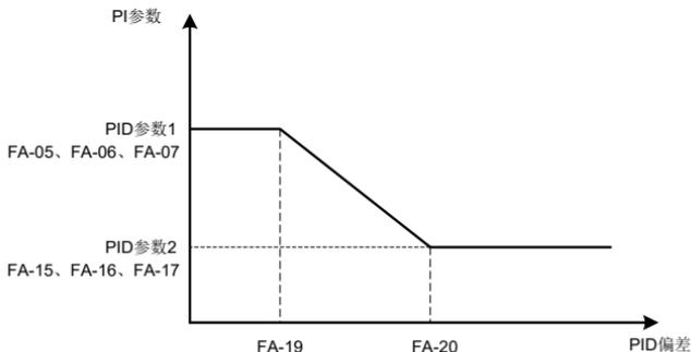
图 6-33 PID 参数切换
