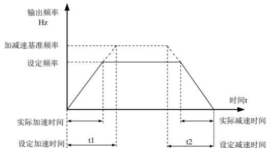
图 6-2 加减速时间示意图
