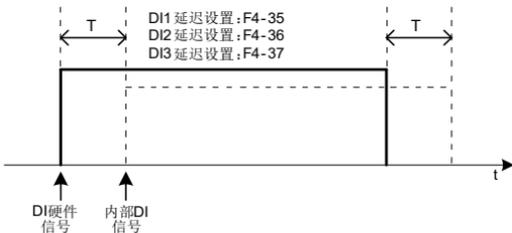
图 4-28 端口信号延迟功能
