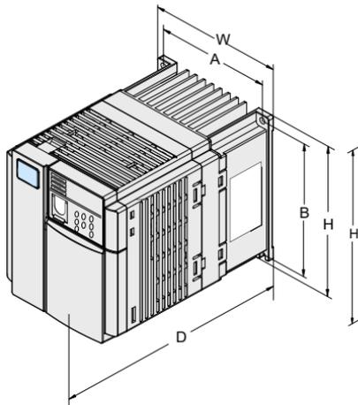
0.4kW-2.2kW 外形及安装尺寸示意图
