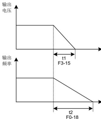
图 6-7 V/F 分离输出电压 / 频率独立减至 0
