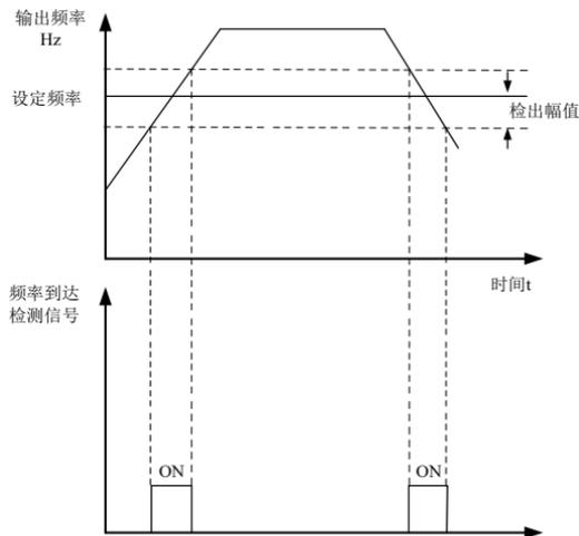
图 6-23 频率到达检出幅值示意图
