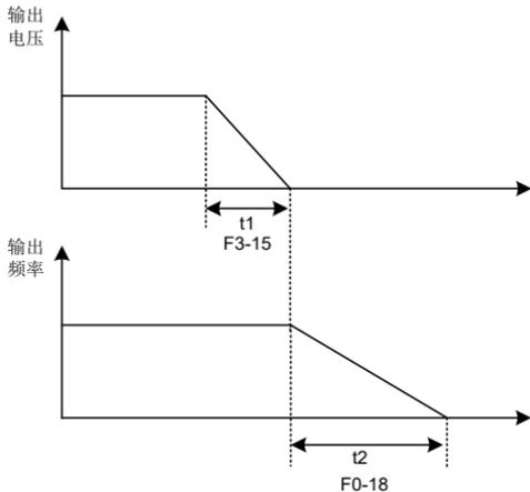
图 6-8 V/F 分离频率 / 电压先后下降示意图
