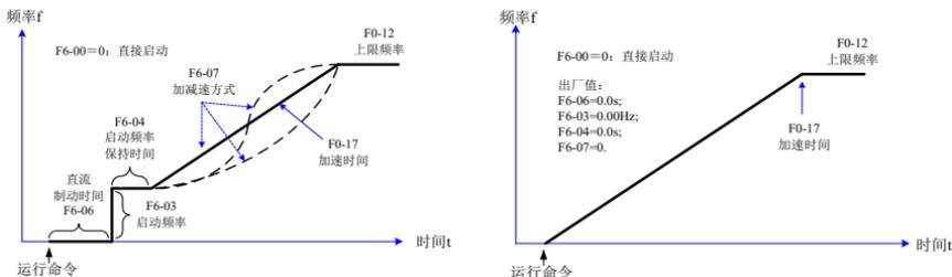
图 4-9 直接启动方式
