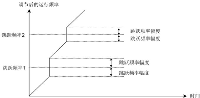
图 6-24 加减速过程中跳跃频率有效示意图
