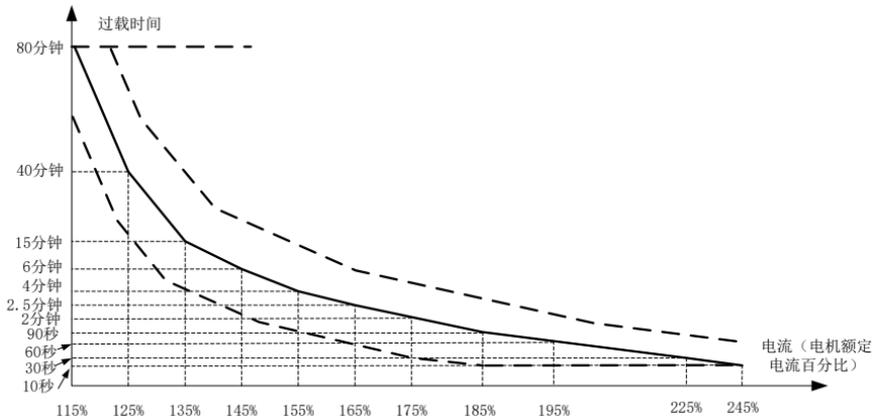
图 6-30 电机过载保护反时限曲线示意图
