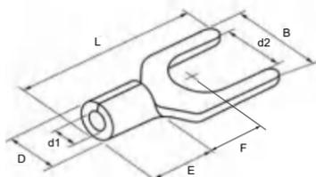
图 3-12 TNS 系列叉形线耳外观及尺寸图（【注】）
