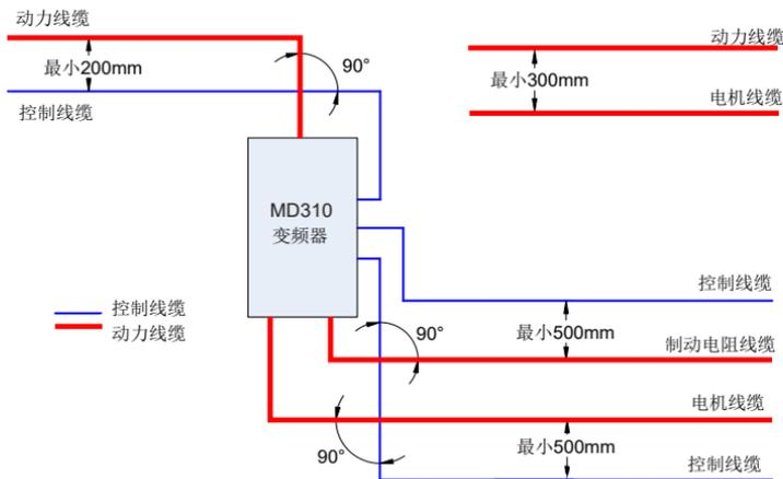
图 7-7 电缆布线图
