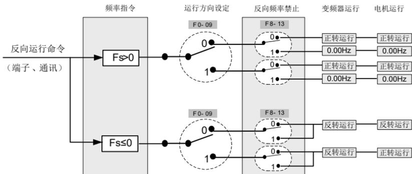
图 4-23 电机运转方向设置
